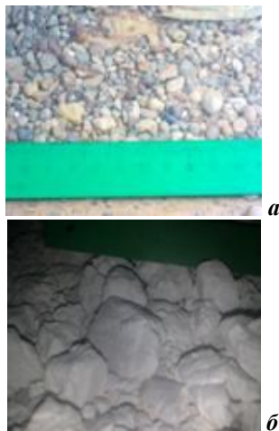
Рис. 1. Фрагменты фотографий для оценки гранулометрического состава материалов: а – гранулы плавикового шпата \text{CaF}_2 ; б – гранулы известняка
