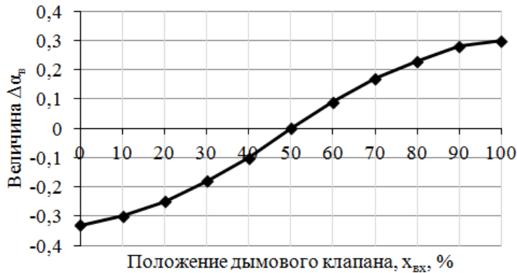
Рис. 1. Экспериментальная зависимость \Delta\alpha_v(\tau) = Y[x_{вх}(\tau)] для печи камерного типа при \alpha_{вх}(\tau) = 1
